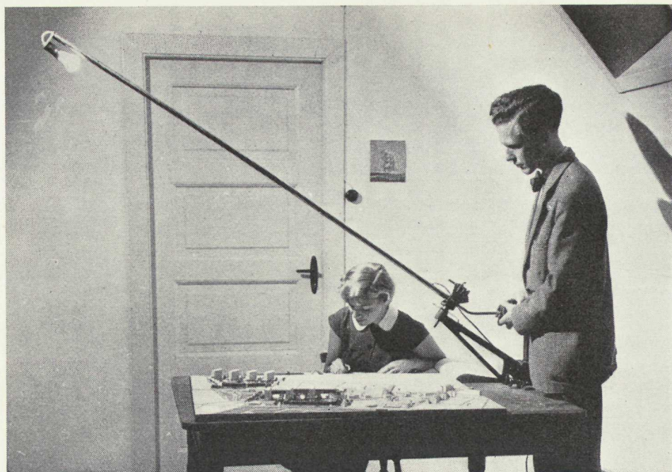
Solbelysningen på projekterad bebyggelse kan studeras med hjälp av en s. k. heliomobil. (Jfr bilaga 3.)
