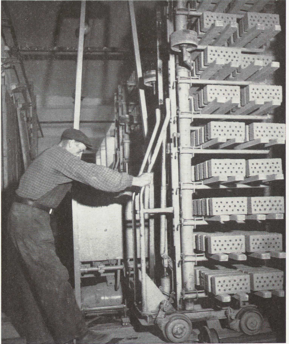
Bild 203. Gaffelvagn med nyformat tegel för insättning i konsttork.
