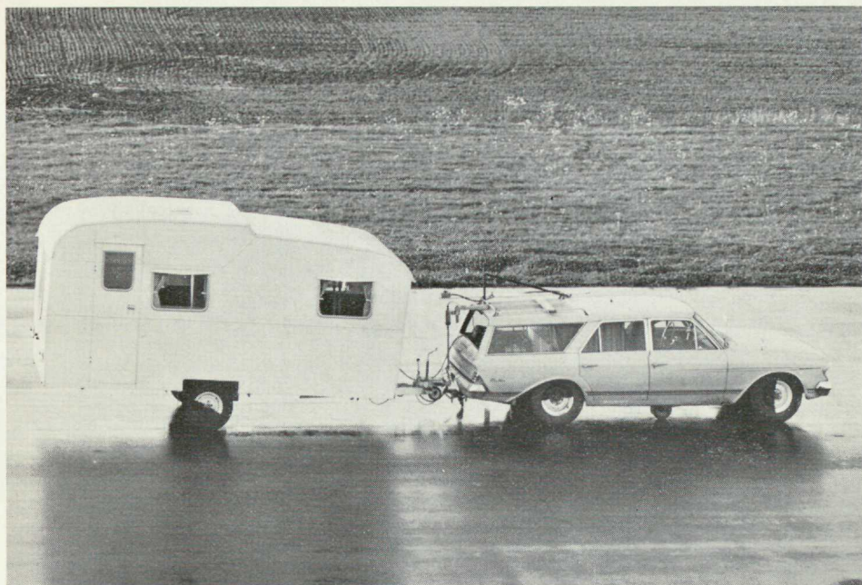
Figur G.14. Dragfordon och släpfordon med utrustning för mätning av vissa dynamiska förlopp. Dragfordonet är utrustat för registrering av dessa
