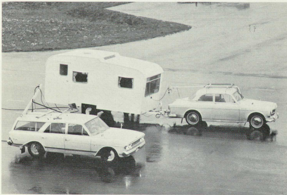
Figur G.15. Dragfordon och släpfordon med utrustning för mätning av vissa dynamiska förlopp. Mätdata överföres via släpkabel till följefordon utrustat för registrering av dessa
