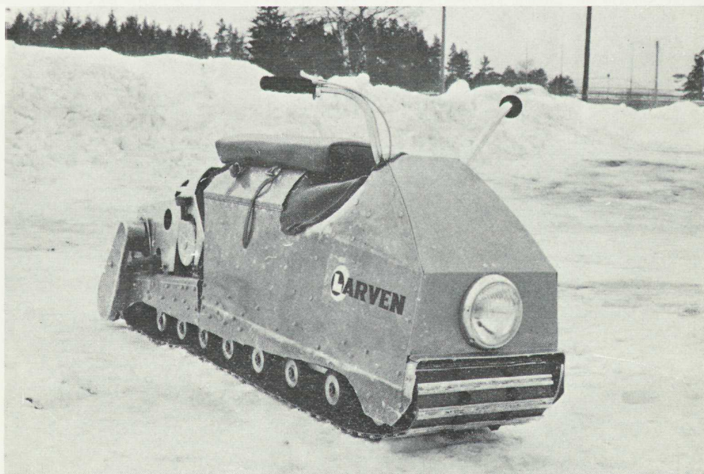
Bandmotorcykel utan styrinrättning, avsedd att styras med förarens egna skidor.
