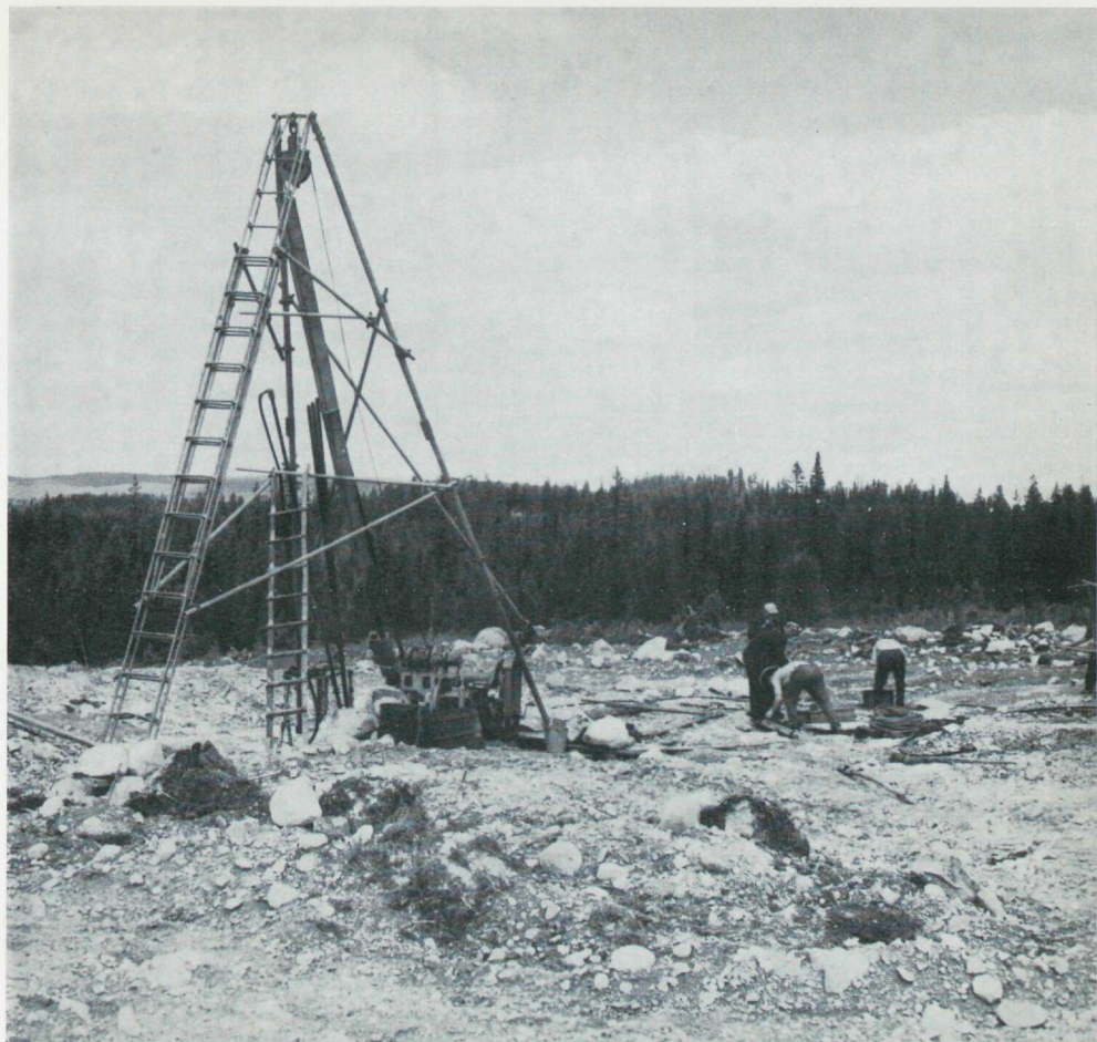
Diamantborrning vidtar, när man med geologiska och geofysiska metoder spårat det sannolika läget av en malmförekomst. (Mossbodarna fäb., Överhogdal s:n, P. H. Lundegårdh foto 1962)
