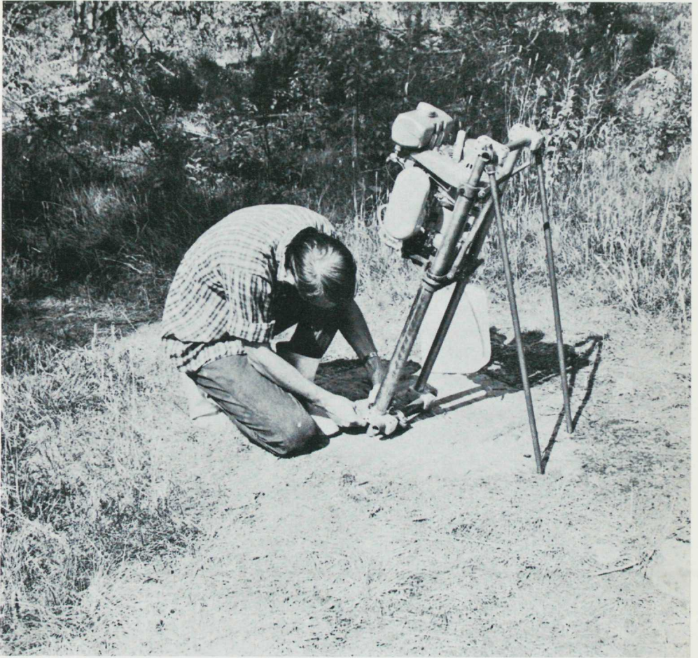
Provtagning av berggrunden med bärbar bormaskin (Levanto-borr). (Dylta, Örebro län, P. H. Lundegårdh foto 1969)
