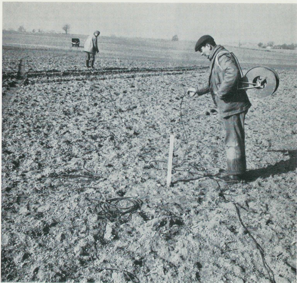
Geofysiska mätningar har länge spelat en viktig roll vid malmprospektering och har numera fått ökad betydelse även för kartering. Bilden visar utläggning av kablar för seismisk mätning, som skall visa jordlagrens mäktighet och berggrundens lagerställning på större djup. (Utläggning av geofoner, Köpingsbro, Malmöhus län, P. H. Lundegårdh foto 1964)
