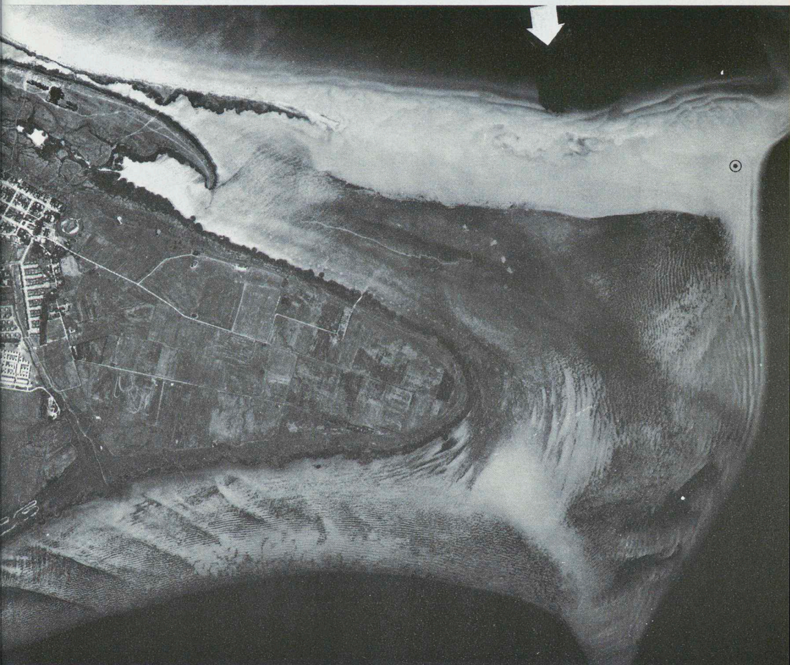
Bild 12 Sandsugning i havsområdena kan medföra risk för erosionsfenomen av skilda slag. Flygfoto- ret som är taget från 3 300 m höjd föreställer norra delen av Skanör-Falsterbo-näset. Vid pilen har under de senaste åren intensiv sugning av framför allt glassand bedrivits. Prickarna utgör spår efter sugröret, 3 å 4 meters fördjupning har inträffat över ett område med ca 400 m längd och 100 å 150 m bredd. Den markerade punkten är en baspunkt i det svenska baslinjenätet. Möjligheten finns att baspunkten genom erosion förorsakad av sandsugningen försvinner under vattenytan. Inför den möjligheten har de pågående företagen ålagt att bekosta kontrollmätningar i området. (Foto: Rikets allmänna kartverk.)
