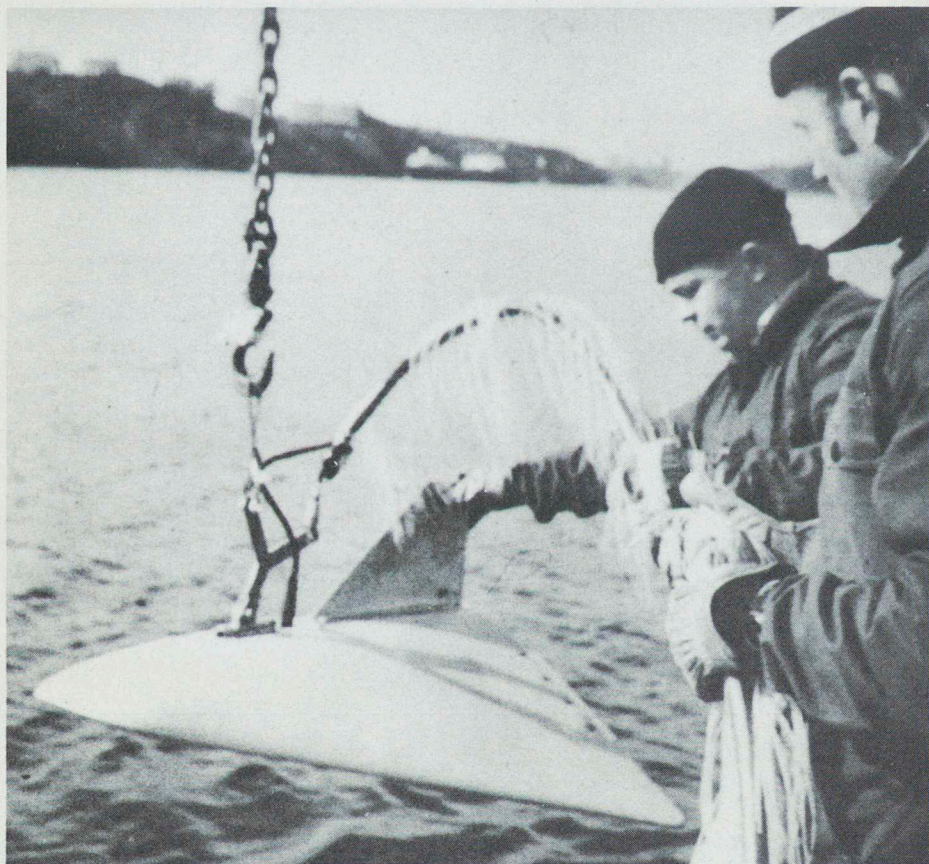
Bild 15 Sveriges meteorologiska och hydrologiska institut (SMHI) utför recipientundersökningar när industrier kustlokaliseras. Kartläggning av temperaturförhållandena i vattenområden där kylvattenutsläpp från kraftverk sker eller planeras är en sådan uppgift. Skärplanet på bilden dras i en kabel efter ett fartyg på önskat vattendjup. I kabeln finns temperaturregistrerande element (termistorer) som ger temperaturen på skilda djup mellan ytan och skärplanet. (Foto: Ulf Karström.)
