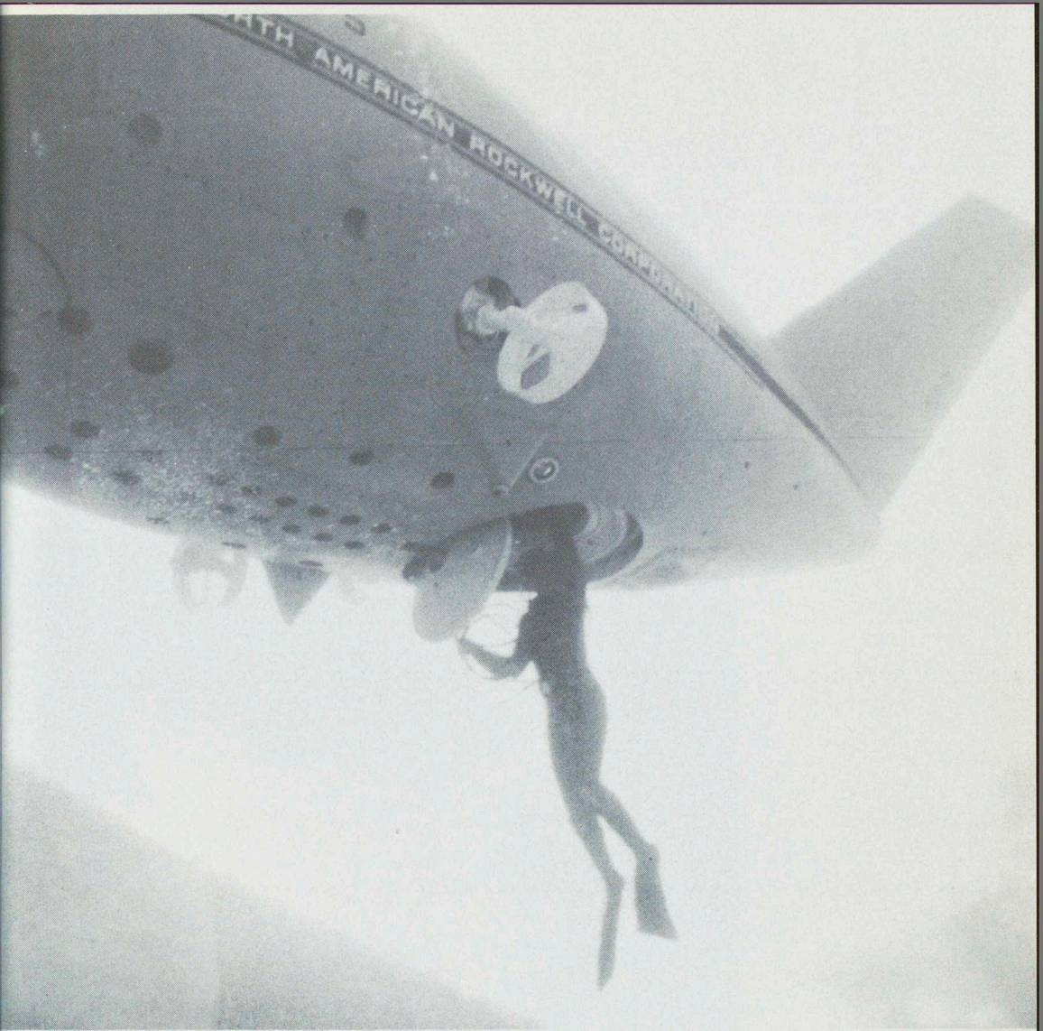
Bild 23 Slussning av dykare från den amerikanska forskningsubåten Beaver Mk IV. (Foto: North American Rockwell Corporation.)
