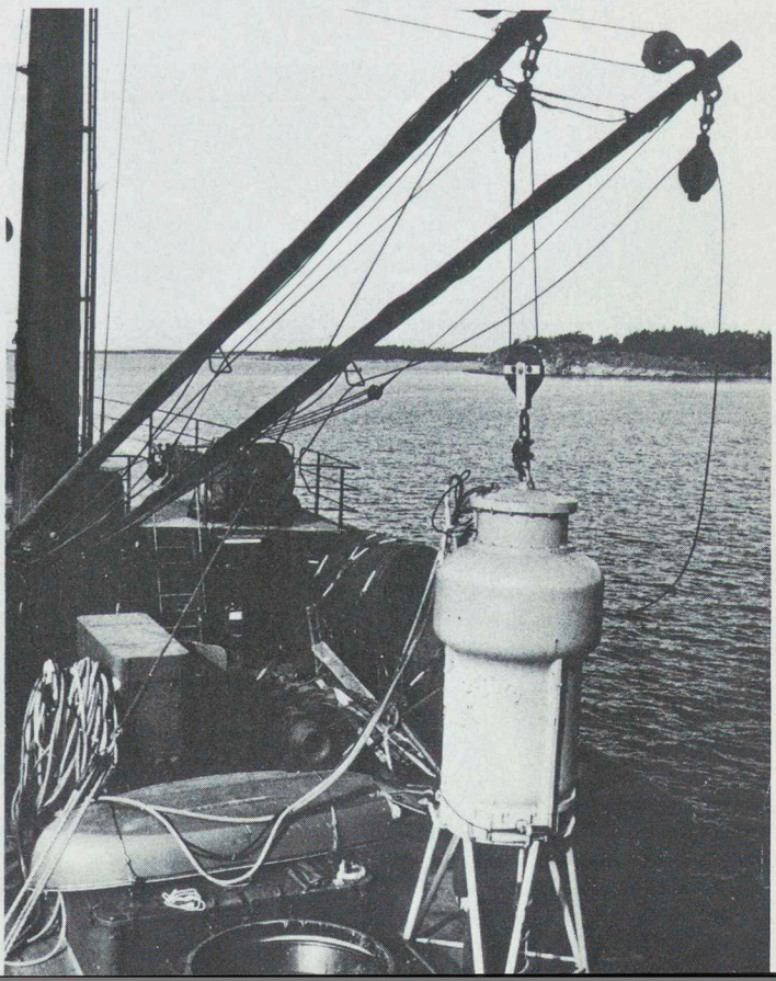
29 och 30 Dykeritekniskt utveck- arbete ombord på marinens ubåts- ningsfartyg Belos. Syftet är att få ett system och en teknik som ger rutinemässigt dykeriarbete på 120 m. På den ena bilden går dykaren in i sin Helioxutrustning i dykar- kammaren. På den andra bilden ses dykar- kammaren och till vänster dess tryckfasta anslutning till rekompresionskammaren ombord.
