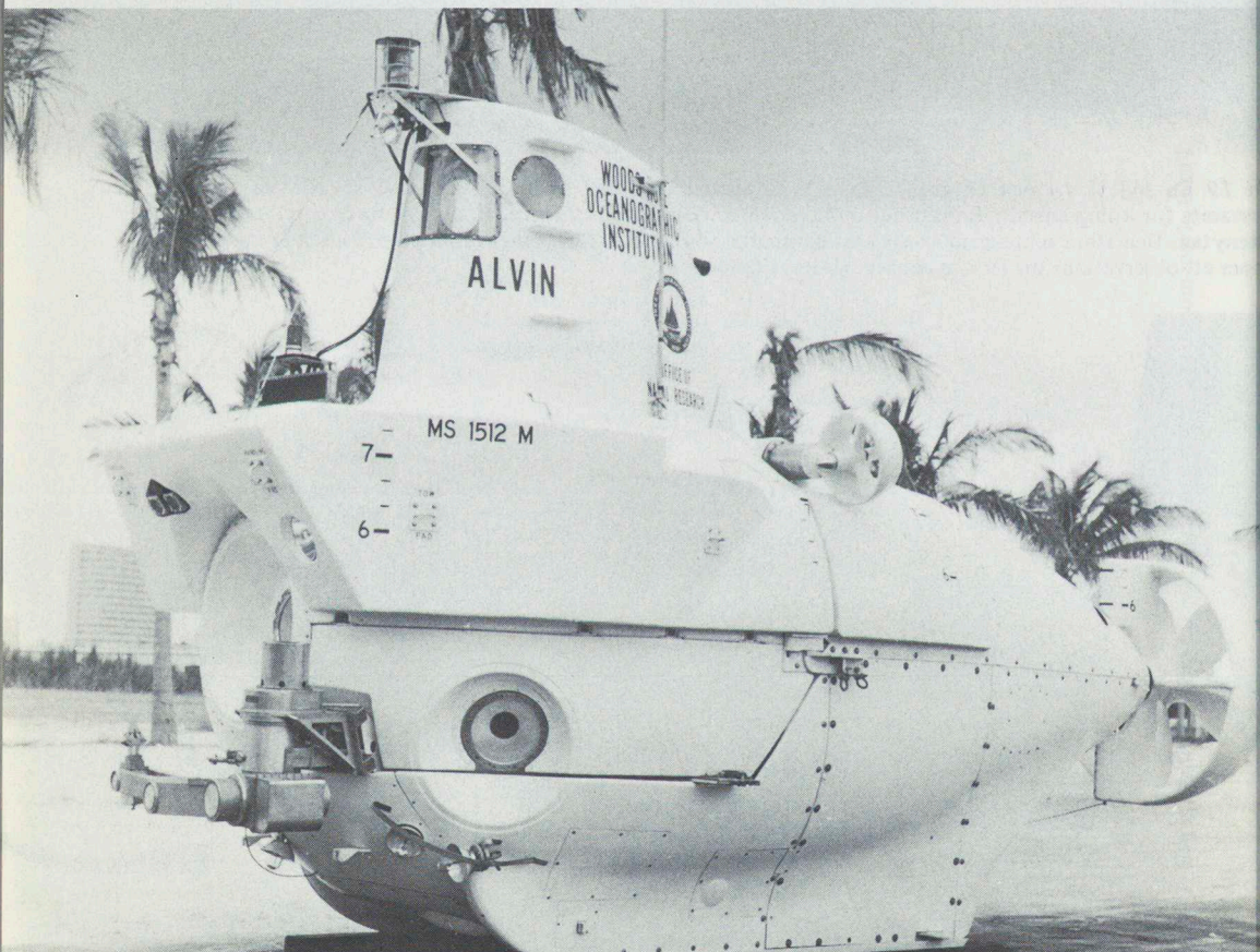
Bild 22 Den amerikanska forskningsbåten "Alvin" för 2 000 m dyk djup och 2 mans besättning. Upplyst att den sjönk 1968 genom en olyckshändelse och bärgades 1969. Man planerar nu en ombyggnad varvid "Alvin" skall få ett skrov i titan vilket beräknas medge dyk djup ned till 3 600 m. (Foto: Woods Hole Oceanographic Institution.)
