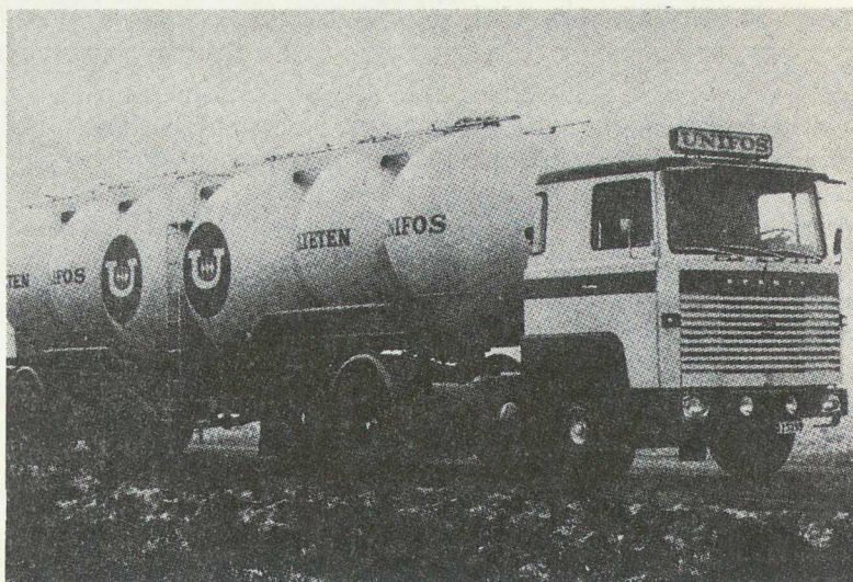
Figur 1:16 Bulktransportfordon för polyeten. Kapacitet 20 ton.
