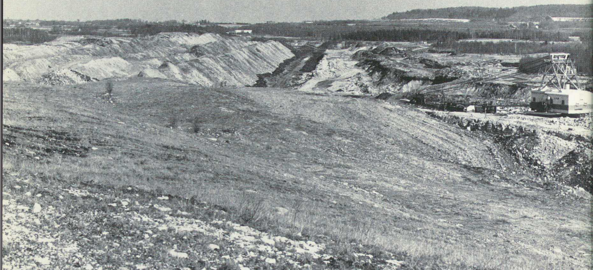
Figur 34. Befintligt dagbrott för uranskiffer i Ranstad. Själva skifferbrytningen sker i den smala zonen i mitten. Längst till höger ligger det orörda landskapet. Till vänster återfylls med schaktmassor varefter landskapet återställs så långt möjligt genom återtäckning med jord och plantering (se även faktaruta 26 på s 180. Bilden belyser allmänt den typ av ingrepp i naturen som uppkommer vid dagbrytning av energiråvaror som skiffer och kol. Ingreppens storlek i förhållande till den utvunna energimängden varierar dock avsevärt (se texten).
