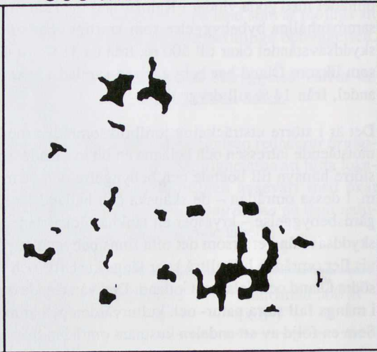
Figur 36 Bilden visar en del av kusten vid Landskrona. Svarta områden är de där vinden har ett energiinnehåll på över 4 MWh/kvm och är och där skyddsavståndet är 300 resp. 500 m till bebyggelse. Som synes minskar den tillgängliga ytan med ca 75 % när det längre skyddsavståndet väljs. Denna stora reduktion beror på den skånska bebyggelsestrukturen med en relativt utspridd bebyggelse.
